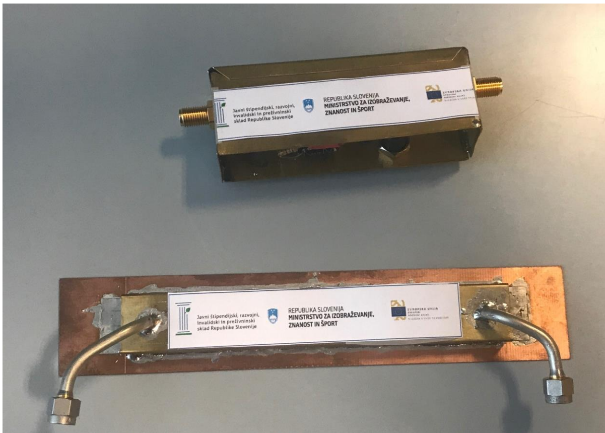
Slika 8: (zgoraj) Dvostopenjski ojačevalnik za 10 GHz in (spodaj) pravokotni valovod, ki deluje kot visokoprepustno sito, je del skupine na FE razvil in sestavlil v okviru projekta, junij.
