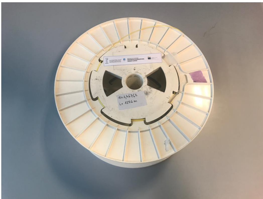
Slika 9: Kolut optičnega vlakna, ki ga je študent skupine na FE navil, umeril in uporabil pri vključitvi v optično sito z neskončnim odzivom (IIR), junij.
